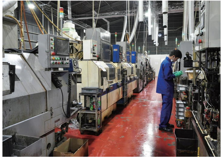
偏芯ベアリング加工ライン Eccentric bearing processing line
