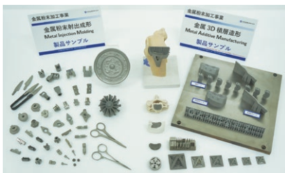
MIM および 3D プリンターで製造された部品 Parts manufactured through MIM and 3D printing 通过 MIM 和 3D 打印机制造的部件
