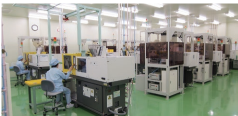
高精度ファインセラミックス成形室 High-precision, fine ceramic injection molding room
