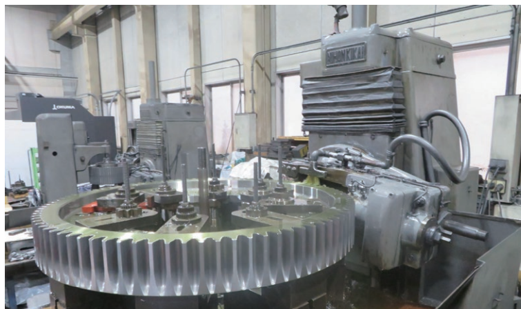
歯切り加工（φ10mm～φ1800mmまで加工可能） Gear cutting (we can handle φ10 mm to φ1,800 mm)
