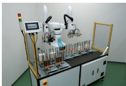
受注開発の合い紙供給ロボット Developed-to-order supply robot for laminated paper
