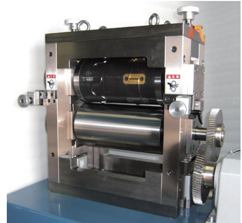
ダイカットロールユニット Die-cutting cylinder unit
