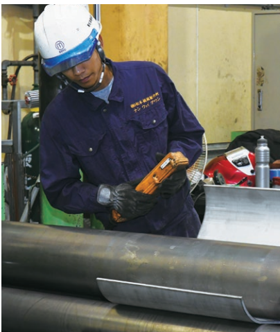
3本のローラーの間に鋼板をセットして巻いていく Rolling a metal plate by setting it among 3 rollers
