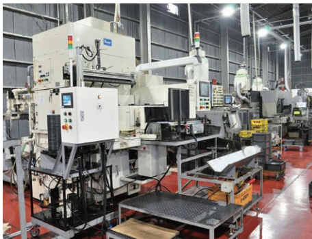
薄肉ボール&ローラーBRG加工ライン Processing line for thin-wall ball/roller bearings
