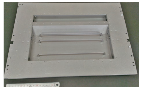
スポット溶接をプレスカシメ工程に変更の製品 Product changed from spot welding to press crimping
