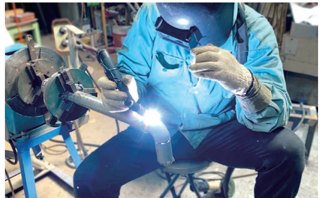
自社開発の裏波溶接装置を使用 We use an internally developed uranami welding device
